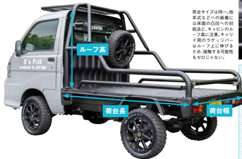
荷台サイズは同一。他年式などへの装着には床面の凸凹への対処法と、キャビンのルーフ高に注意。キャリア用のラゲッジバーはルーフ上に伸びるため、接触する可能性もゼロじゃない。
