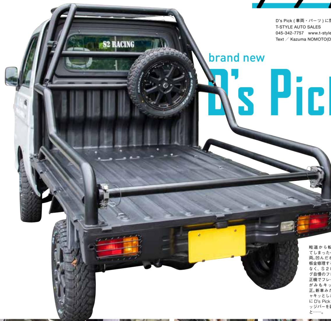
畦道から転げ落ちてしまったベース車両。凹んだボディを板金修理するだけでなく、S2レーシング自慢のフレーム修正機でフレームのゆがみもキッチリ修正。新車みたいにシャキッとしたボディにD's Pickのラゲッジバーを装着すると……。
