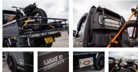
バイクの積み降ろし作業を考えるとローダウンはトランポ仕様では実用的なカスタム。「ガード」はタイヤを押し付けて固定するのに最適で、大きなバイクを積むには「カーゴゲート」は欠かせない。
