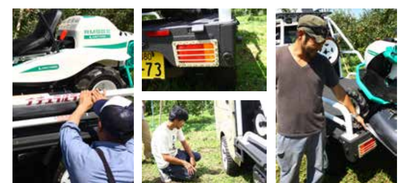
アルミブリッジを掛ける部分やテールランプは仕事から破損しやすい箇所。さらに4WDは必須。その点で、荷台に強度アップのLINE-X、テールランプガードを装着したD's Pickの評価は高い。ということで、お墨付の証に特製ステッカーを。あとはロールケージの荷台を活かす活用方法を考えると……
