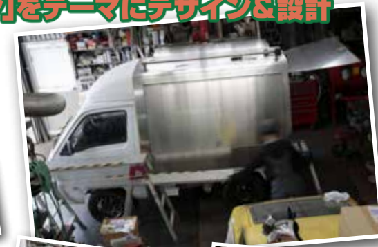
デザイン時に重視したカタマリ感を生み出すためにアルミバンのサイド面はキャビンとルーフポイラーと一体化する丸みを帯びた形状に。車体左側の荷台アオリはエンジニア社の依頼により水平固定できるように加工してある。
