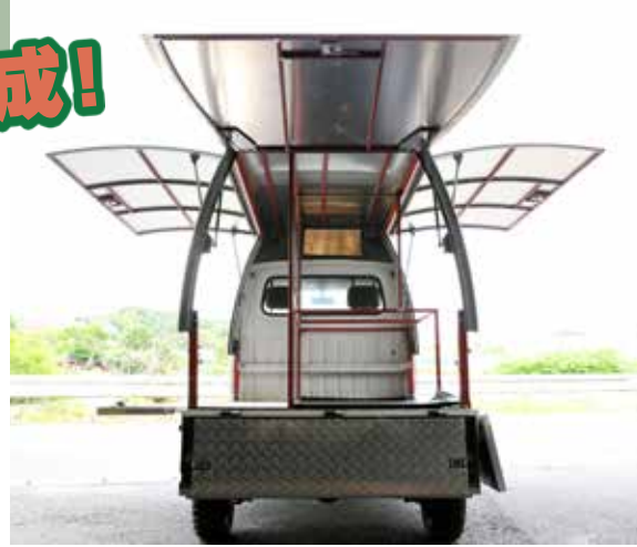
デザイン時に重視したカタマリ感を生み出すためにアルミバンのサイド面はキャビンとルーフポイラーと一体化する丸みを帯びた形状に。車体左側の荷台アオリはエンジニア社の依頼により水平固定できるように加工してある。
