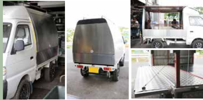
デザイン時に重視したカタマリ感を生み出すためにアルミバンのサイド面はキャビンとルーフポイラーと一体化する丸みを帯びた形状に。車体左側の荷台アオリはエンジニア社の依頼により水平固定できるように加工してある。
