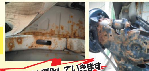
車の骨組み(フレーム)はすべて鉄製なのはご存知でしょうか？鉄は錆びますね。
